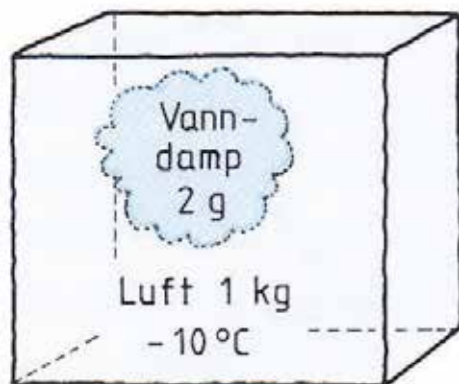
Uteluft 90 % RF 240 Pa vanndamptrykk.
