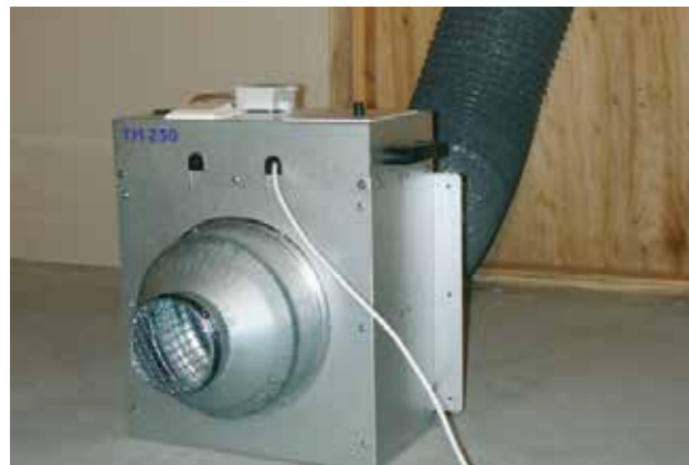
Enkel lekkasjemåler montert i byggedør.
