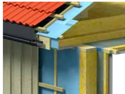
Figur 3. Tak med kaldt utluftet loft.
